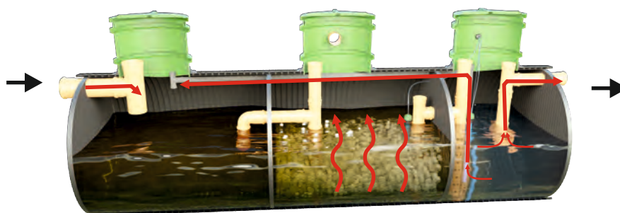
B) - okresowa recyrkulacja osadu wraz z przerwami w natlenianiu
