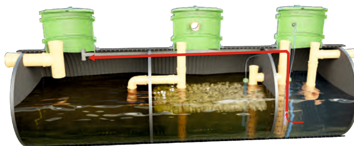
D) - zmniejszenie natleniania z przerwami na recyrkulację osadu (okres nocny)
