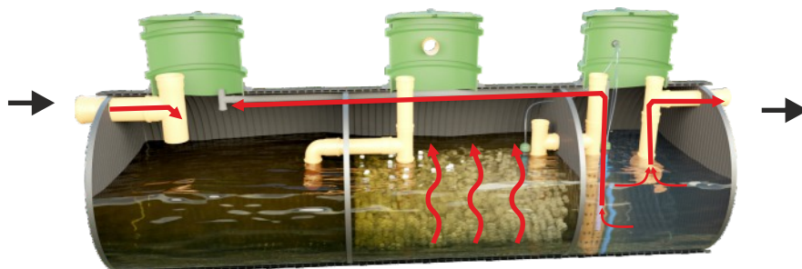
B) - okresowa recyrkulacja osadu wraz z przerwami w natlenianiu
