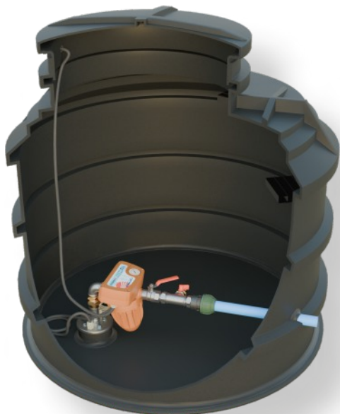
Przykładowa konfiguracja wyposażenia obudowy OSG 100/1,25, z elektronicznym wyłącznikiem pompy do sterowania automatycznego (taka konfiguracja zastępuje konieczność stosowania zbiornika przeponowego).
