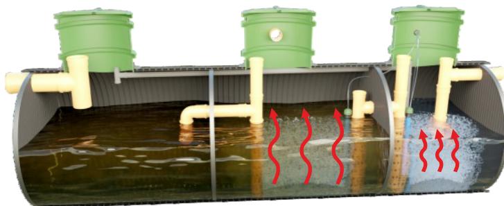
A) - przygotowanie oczyszczalni do przyjęcia pierwszych ścieków w ciągu dnia, poprzez wstępne natlenianie - aktywację komory biol.
